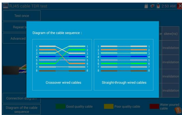
Schemat sekwencji przewodów (cable sequence diagram):
